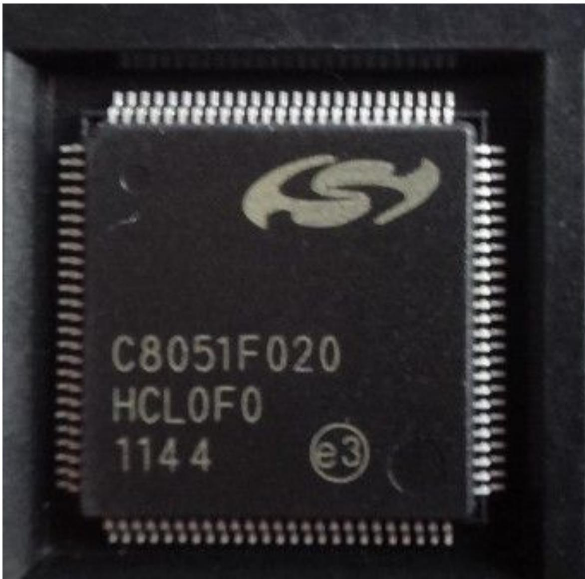
100脚的TQFP封装
